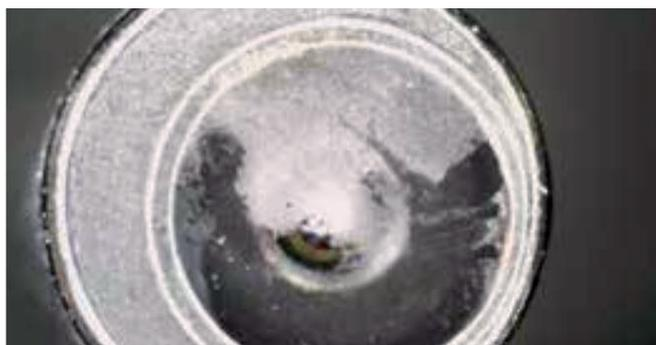
Dettaglio di un'ottica prima del trattamento BICAR<sub>med</sub><sup>®</sup>
