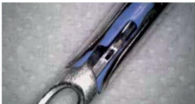
Dettaglio della stessa pinza dopo il trattamento BICAR<sub>med</sub><sup>®</sup>
