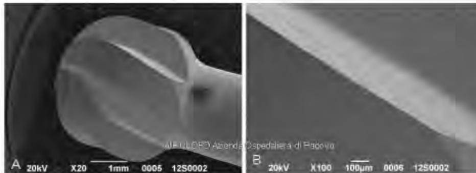
Fig. 3 Fresa Rosetta E8240 LSO 4 MM utilizzata e poi sottoposta a pulizia meccanica
