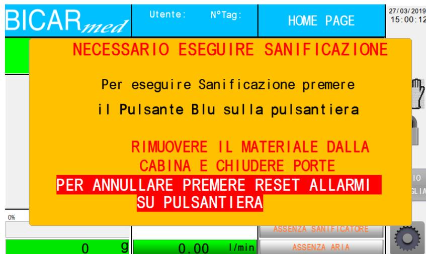
È necessario eseguire la sanificazione: se non viene eseguita, questo viene salvato nel LOG SANIFICAZIONE.
