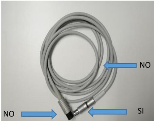
E' possibile trattare solo le estremità di acciaio, non il tubo di plastica.
