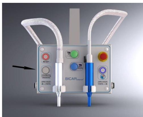
A questo punto il pannello HMI riporterà il messaggio "trasferimento vassoio" e una volta che il vassoio si troverà nella posizione più bassa del caricatore di sinistra, dopo 5 secondi si sgancerà automaticamente e per effetto dei rulli, si porterà a ridosso della cabina.
