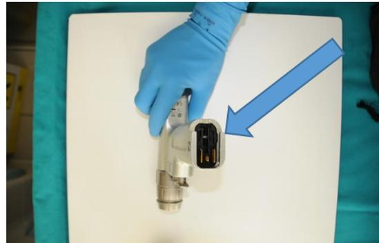
Prestare attenzione alle connessioni elettriche, non usare il getto di bicarbonato, risciacquare soltanto.
