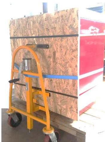
Dopo aver aperto la cassa si procede con il sollevamento della macchina con apposite attrezzature predisposte per lo spostamento di mobili. È possibile dunque trasportare la macchina con gli appositi sollevatori oppure posizionando al di sotto del banco, in corrispondenza delle giunzioni tra la sezione centrale e quelle laterali, due carrelli/pattini.
