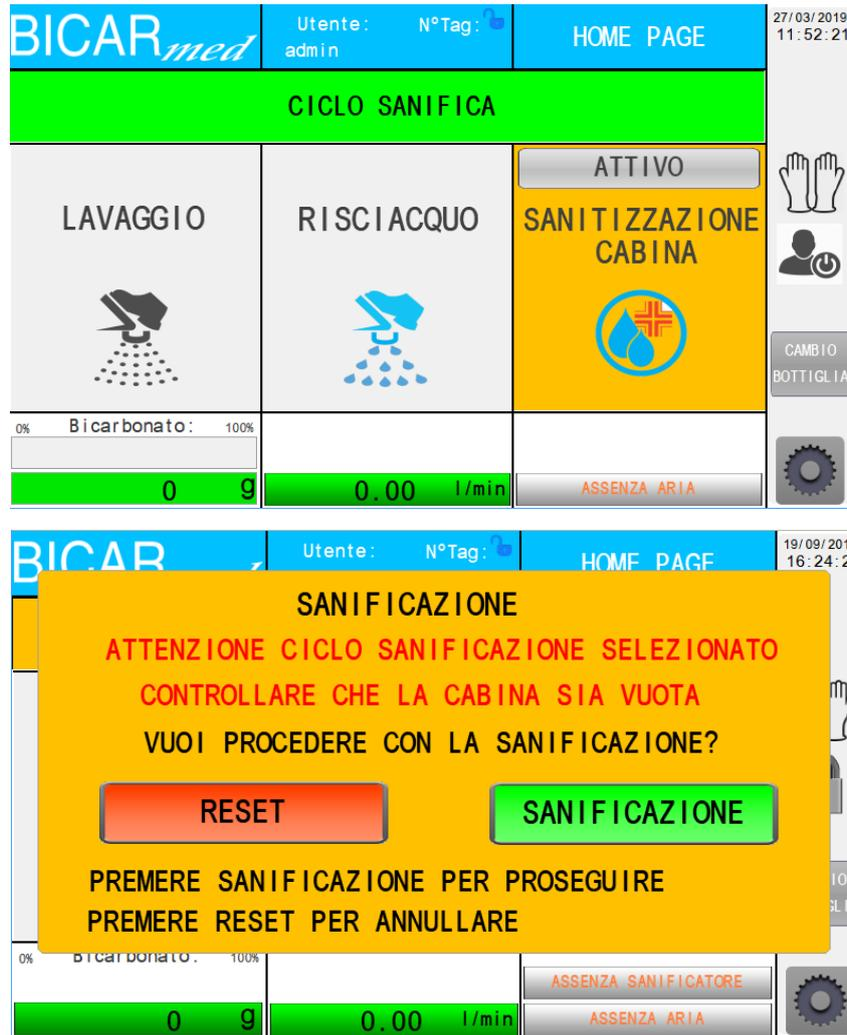
Cycle d'assainissement sélectionné, appuyer sur le bouton d'assainissement pour démarrer, appuyer sur le bouton reset pour annuler.
