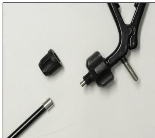
Ne pas traiter le corps en plastique avec le jet. Retirer les différentes pièces afin de traiter les points métalliques et rincer les pièces en plastique à l'eau.
