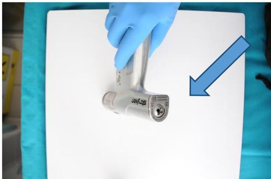
Nettoyer l'intérieur et tester le fluxage. Faire référence à la procédure pour les instruments à canules décrite dans le tutoriel 4.
