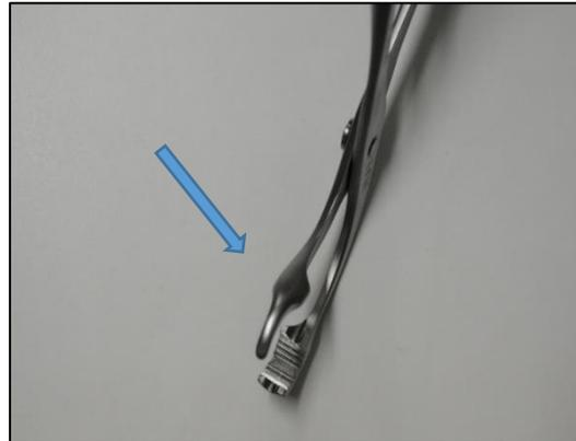
Die gesamte Oberfläche des Stahlwerkzeugs behandeln, die Mutter zur leichteren Reinigung auf der Schraube versetzen und auf den Rändelungen verweilen
