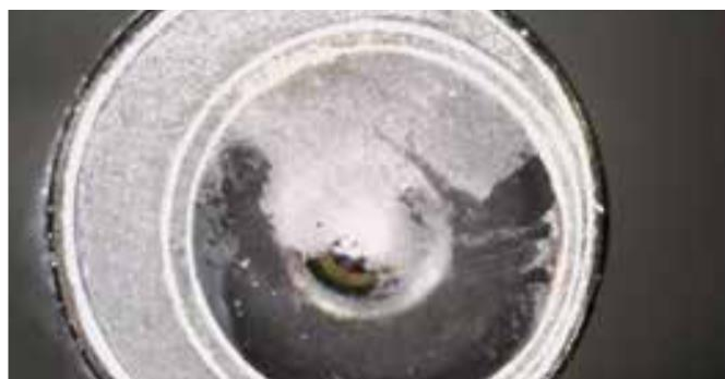
Détail d'une lentille avant le traitement BICAR med ®
